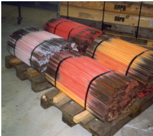
Förankringsstänger dim. 16 mm L=800
